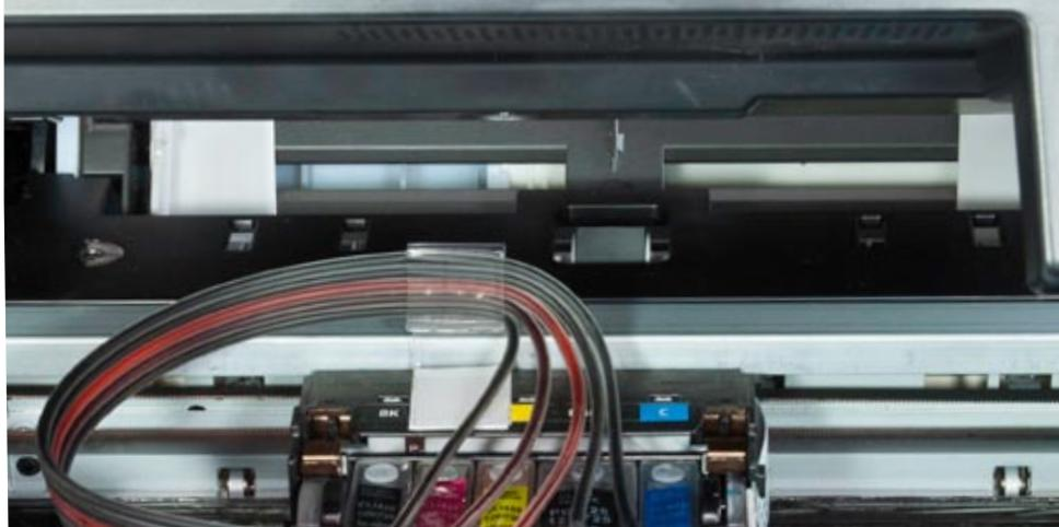
3.11. Поочередно отделите защитную пленку от липкой подложки на основании фиксаторов шлейфа и закрепите их **в строгом соответствии с фото 6-1, 6-2, 6-3, 6-4**. Рекомендуется начинать установку с фиксатора № 3 на печатной каретке и далее, вдоль шлейфа наружу, вплоть до № 1.
