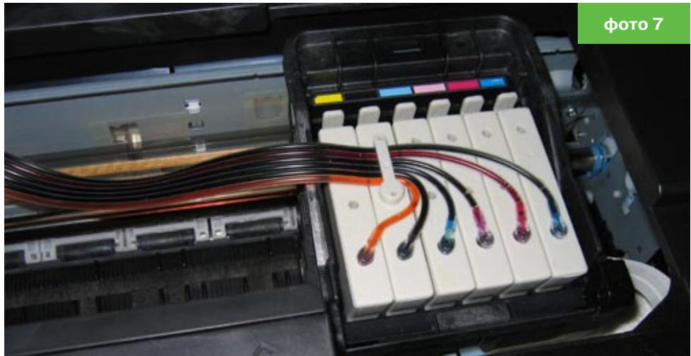
3.8. На предварительно обезжиренное место (**фото 8**) прикрепите держатель шлейфа, отсоединив защитную пленку от липкой подложки. Отрегулируйте укладку шлейфа, чтобы при перемещении каретки не было его заминания или натяжения.
