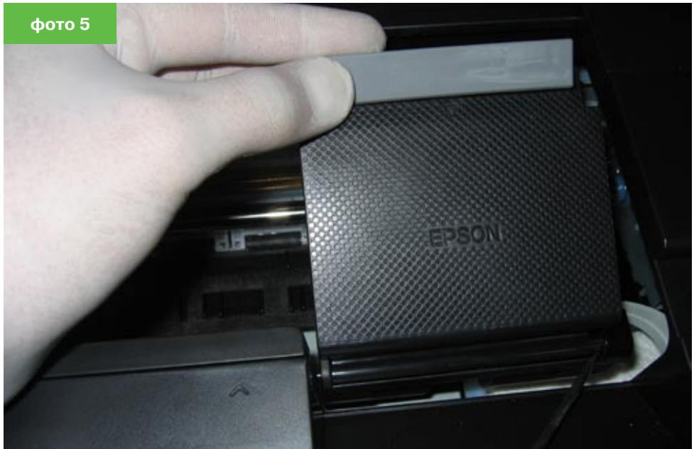
с правой стороны печатной головки с помощью отвертки, одновременно отводя крышку вверх (для T50/R270/R290/1410: **фото 4**, для остальных моделей: **фото 5**). Отсутствие крышки никак не отразится на качестве печати.
