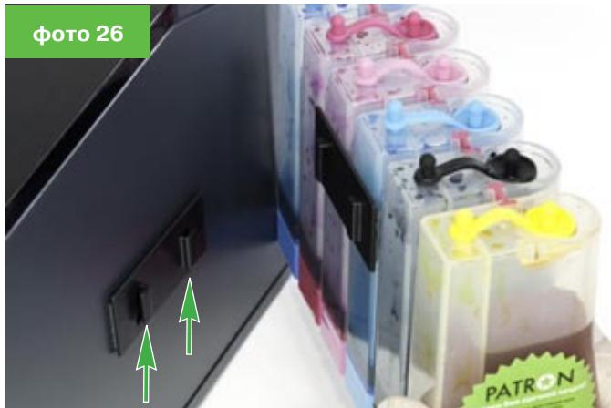
9.4. Проверьте установку снятием емкостей с держателя. Перед снятием пережмите шлейф зажимом, закройте заправочные и компенсационные отверстия в емкостях пробками-заглушками.
