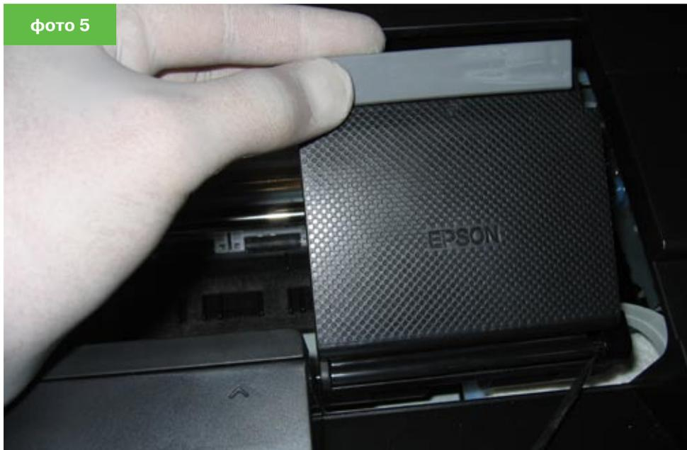
с правой стороны печатной головки с помощью отвертки, одновременно отводя крышку вверх (для T50/R270/R290/1410: **фото 4**, для остальных моделей: **фото 5**). Отсутствие крышки никак не отразится на качестве печати.
