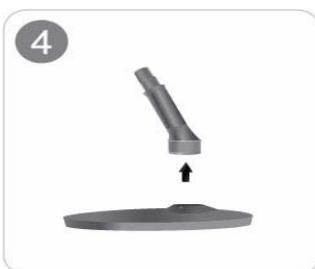
Извлеките соединительный элемент из подставки, потянув его в направлении стрелки, как показано на рисунке.
