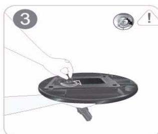
Открутите соединительный винт в нижней части подставки.
