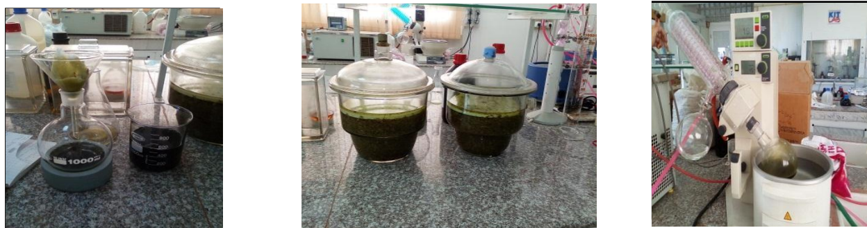
Figure 15: Les différentes étapes de macération, de filtration et d'évaporation de l'extrait hydroalcoolique d'une plante du genre Athamanta
