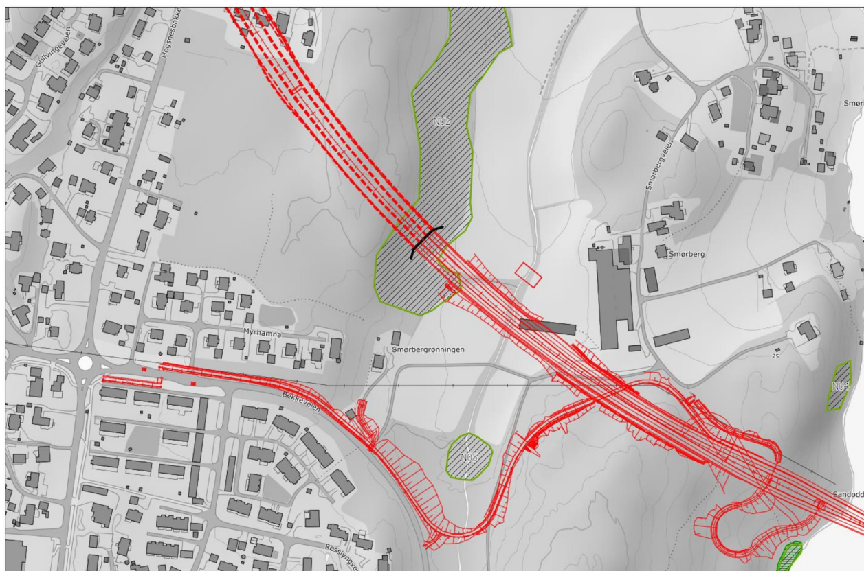
Figur 2-5: Kartutsnitt viser planlagt tiltak, vei i dagen, tunnelpåhugg og videre tunnel i plan. Grønne områder med skraver viser utbredelsen av naturtyper.
