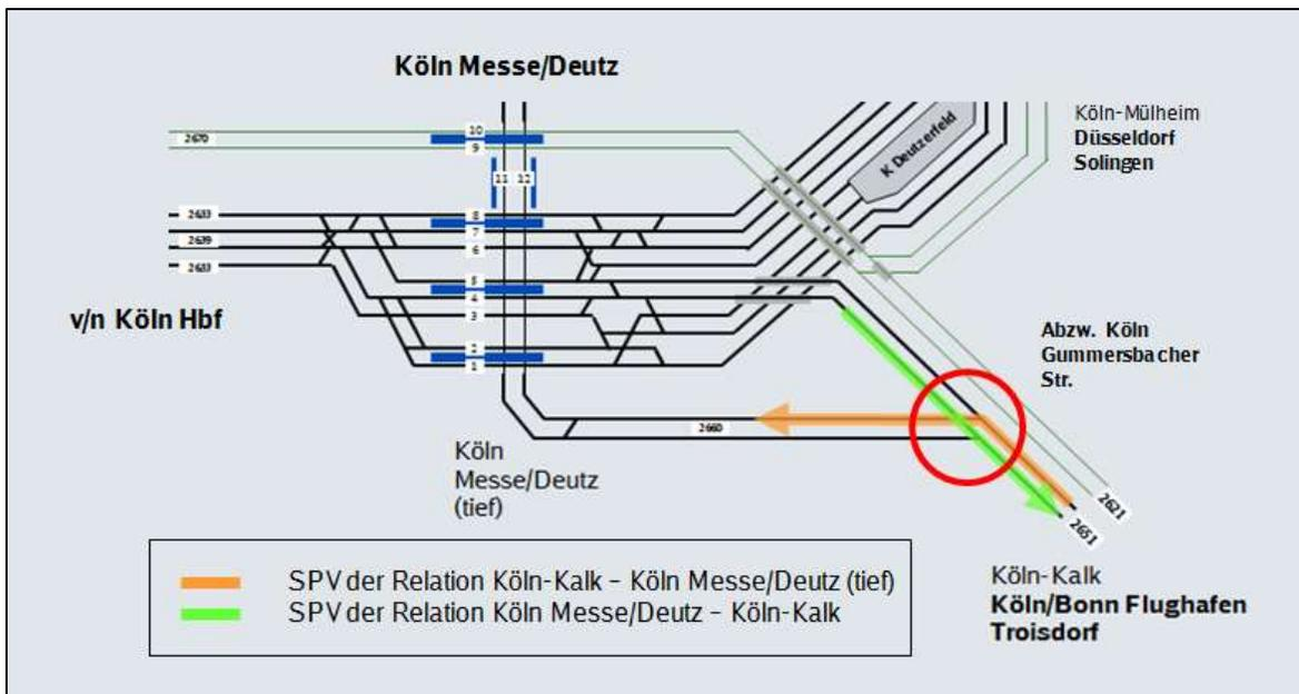
Abbildung 15: Niveaugleiche Fahrwegkreuzungen am Abzw. Gummersbacher Str.
