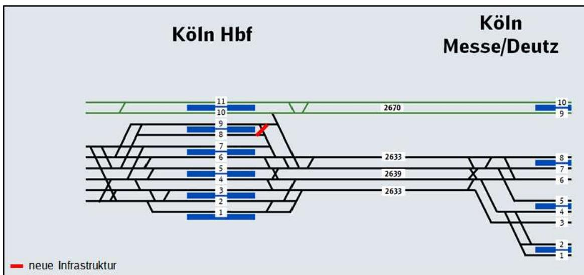
Abbildung 20: Geänderte Weichenverbindung im Ostkopf von Köln Hbf
