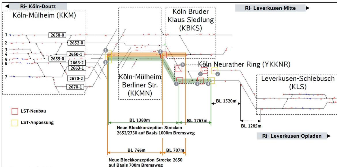
Abbildung 23: Zusätzliche Blockabschnitte an den Strecken 2650 und 2659/2730
