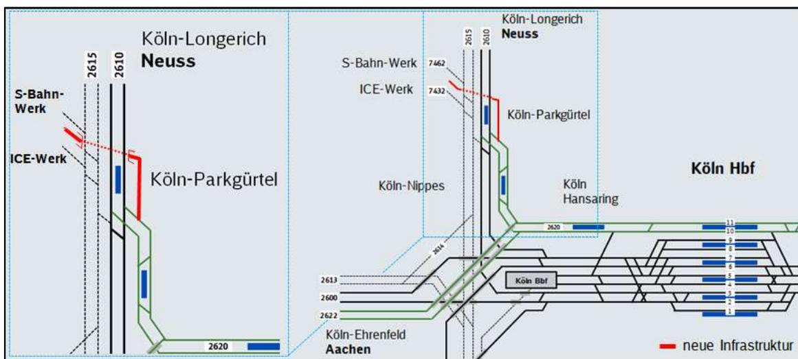
Abbildung 19: Niveaufreie Anbindung des S-Bahnwerkes in Köln-Nippes
