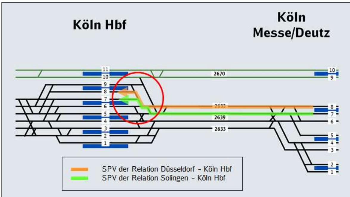
Abbildung 11: Parallele Einfahrten sind im Ostkopf des Kölner Hbf nicht möglich
