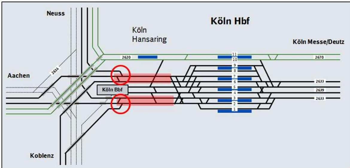
Abbildung 10: Engpasssituation im Westkopf des Kölner Hbf
