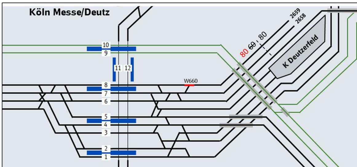
Abbildung 21: Geschwindigkeitserhöhung im Bereich der östlichen Einfahrt von Köln Messe/Deutz
