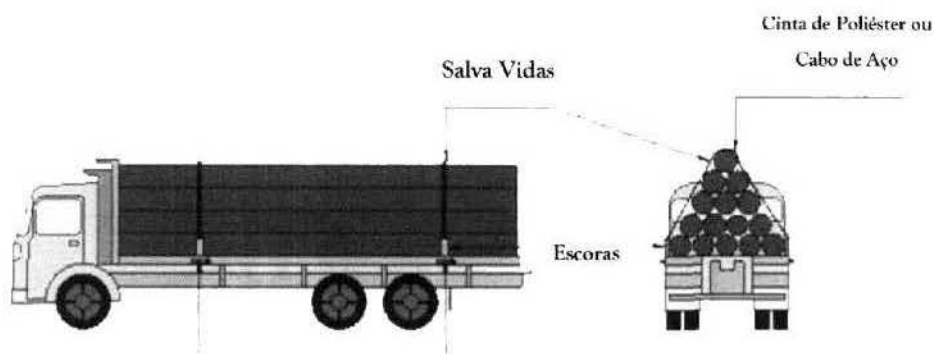
Sistema de sarilhos de amarração ou equivalente ajustável para amarração de cintas de poliéster ou cabos de aço.
