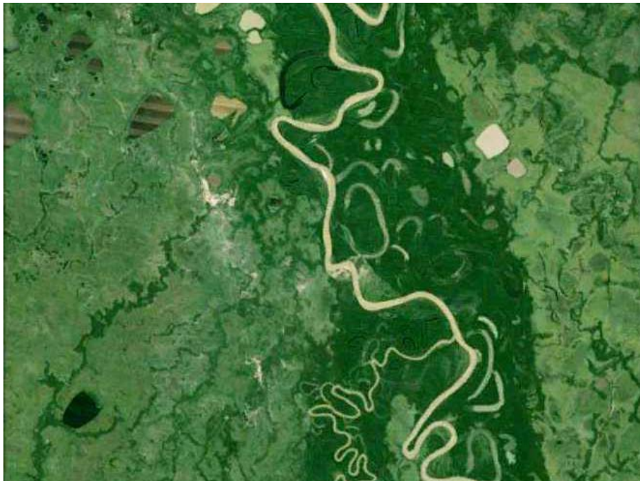
Figura 2. Tipos de cauces: A) Cauces poco sinuosos en pequeños ríos de montaña y cauce anastomosado en río de baja pendiente; B) Cauce meandroso en río de llanura; se aprecia también el bosque ribereño en la llanura de inundación (Imágenes: Google Earth).
