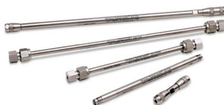
Columnas de vidrio y de acero inoxidable, para cromatografía en columna
