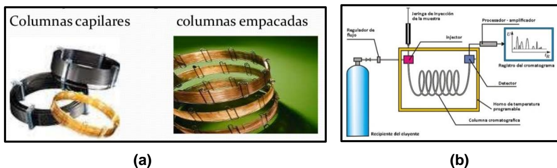
Figura 14: (a) Columnas para cromatografía de gases. (b) Esquema de Funcionamiento de un cromatografo de gases.
