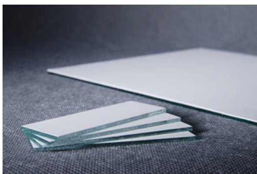
Figura 31: Placas de vidrio y de aluminio, con gel de sílice como adsorbente, para cromatografía en capa fina
