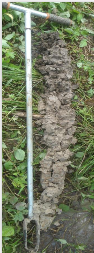
Barrenada en suelo con mal drenaje
