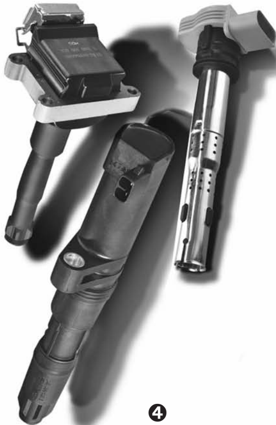
Distintos modelos de bobinas de encendido receptáculo de las bujías / bobinas independientes por cilindro destinadas a los modelos de vehículos de BMW, Fiat, Mercedes-Benz, Porsche, Renault o VW.
