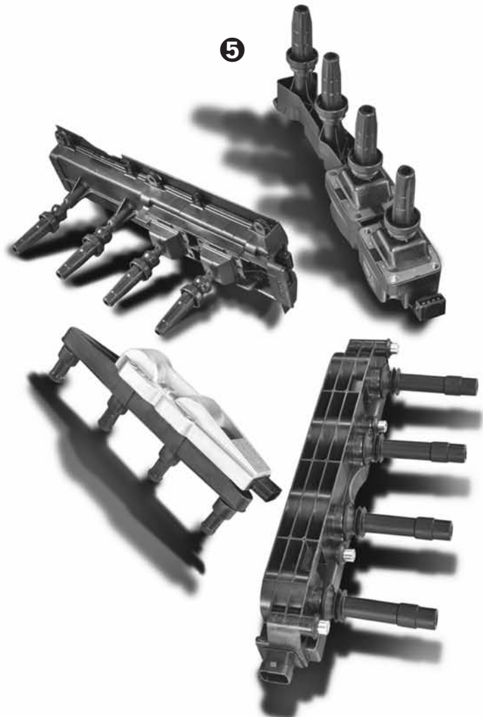
BERU bobinrails voor gebruikelijke voertuigen van VW, Opel, Peugeot, Citroën en Škoda.
