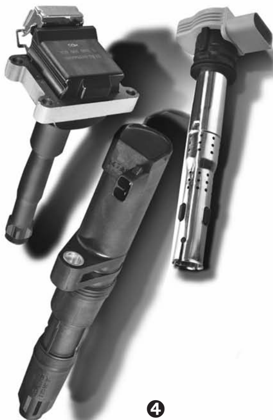
Różne wykonania indywidualnych/wtykowych cewek zapłonowych do pojazdów marki BMW, Fiat, Mercedes-Benz, Porsche, Renault i VW.
