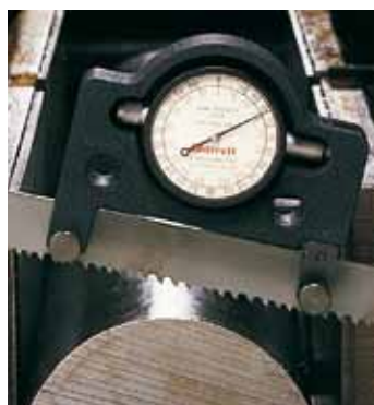
Para una tensión correcta de la hoja, utilice el tensiómetro Starrett 682EMZ (ver página 88).
