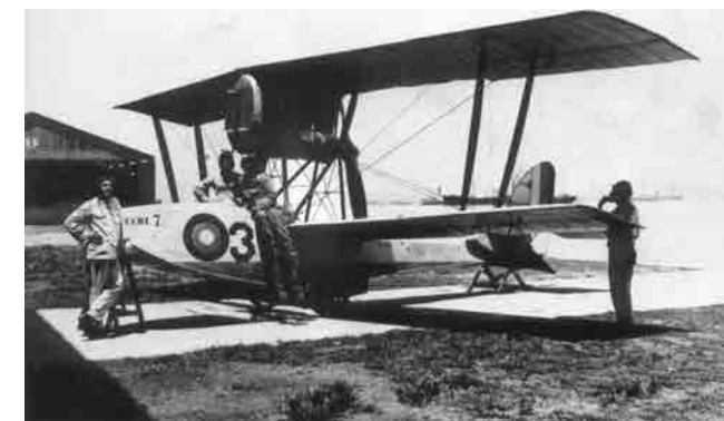
O Macchi M.7 era, originalmente, um aerobote de caça italiano. Três, sem armamento instalado, foram empregados para instrução pela Escola de Aviação Naval.
