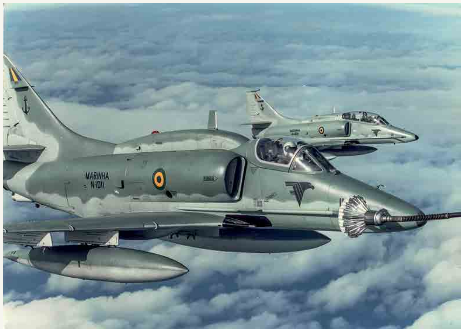
A primeira operação reabastecimento em voo do Esquadrão VF-1 foi em 17 de outubro de 2001, junto com a FAB. Este é o AF-1 Skyhawk N-1011 na cesta de REVO do avião-tanque KC-130 Hércules. O biplace AF-1A N-1021 está na posição de espera.
