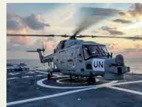
Helicóptero AH-11A Super Lynx N-4011 na fragata F-45 União em operação com as forças da ONU na missão de paz UNIFIL em novembro de 2011. Notar o sensor infravermelho Star Safire III montado no nariz.
