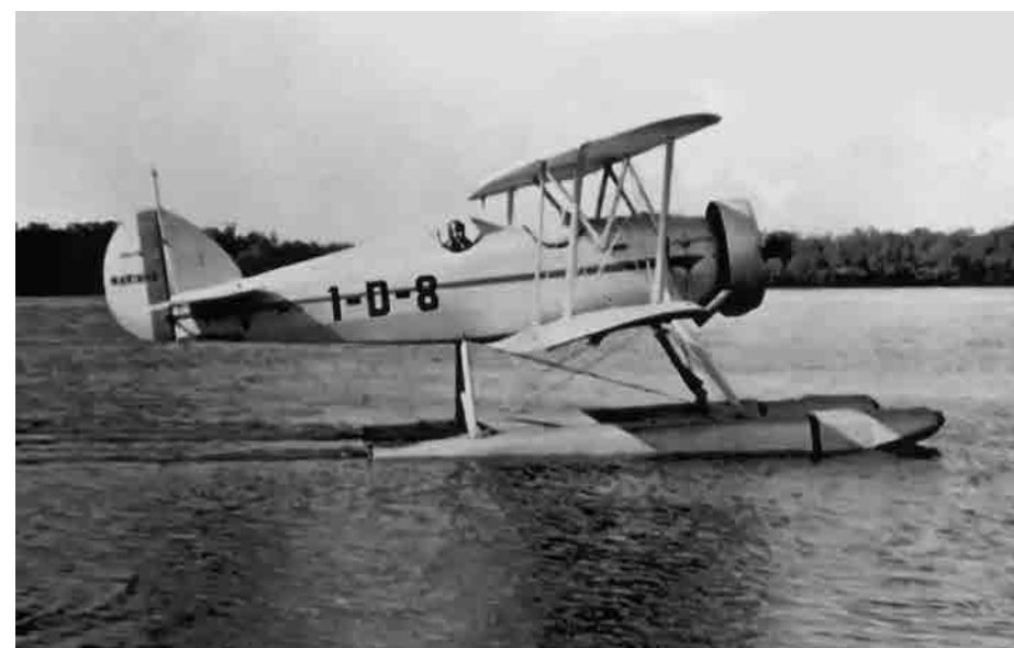
Um dos oito Waco CSO usados para ligação/Correio Aéreo. Em comum com muitos outros tipos, podiam ser montados sobre rodas ou flutuadores.
