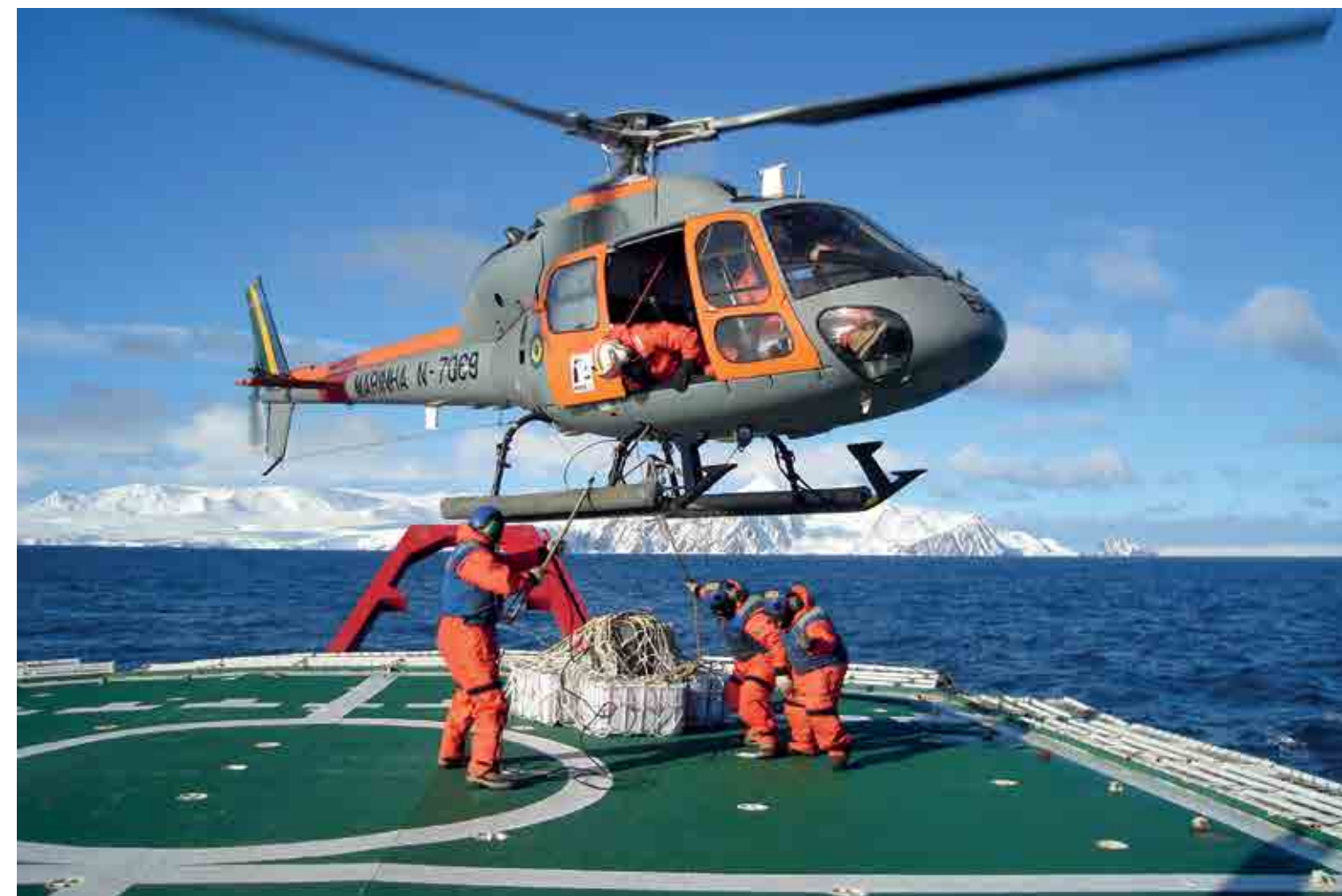
O UH-2 Wasp foi substituído nas missões Operantar pelo UH-13 Esquilo bi de duas turbinas, oferecendo maior capacidade e segurança nas condições extremas do local.
