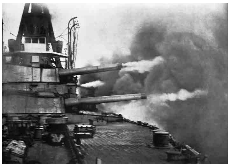
Quando entrou em serviço, o Minas Geraes era a belonave mais poderosa do mundo. Nesta foto, feita durante as provas de mar em 1909, mostra uma salva dos dez canhões de 12 polegadas, a mais pesada até então disparada por um navio.
