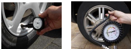
Figura 5. Matja e presionit të pneumatikëve me manometër
