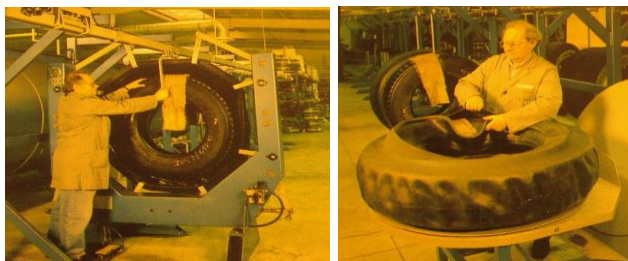
Figura 25. Montimi i pneumatikut të jashtëm dhe montimi i pneumatikut të brendëshëm
