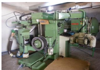
Figura 33. Makina për prerjen e rrethit të pneumatikut
