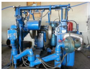
Figura 34. Makina për zhveshjen e pneumatikëve
