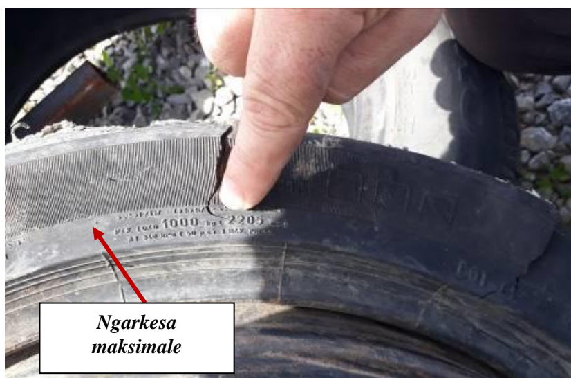
Figura 5.15. Pjesë të pneumatikut të rrotës së djathtë të pasme, ku evidentohet ngarkesa maksimale e rrotës 1000 kg (2205 lbs), në presion maksimal 340 kPa (50 p.s.i) (Fotografitë gjatë Ekzaminimit të gjendjes teknike të automjetit)
