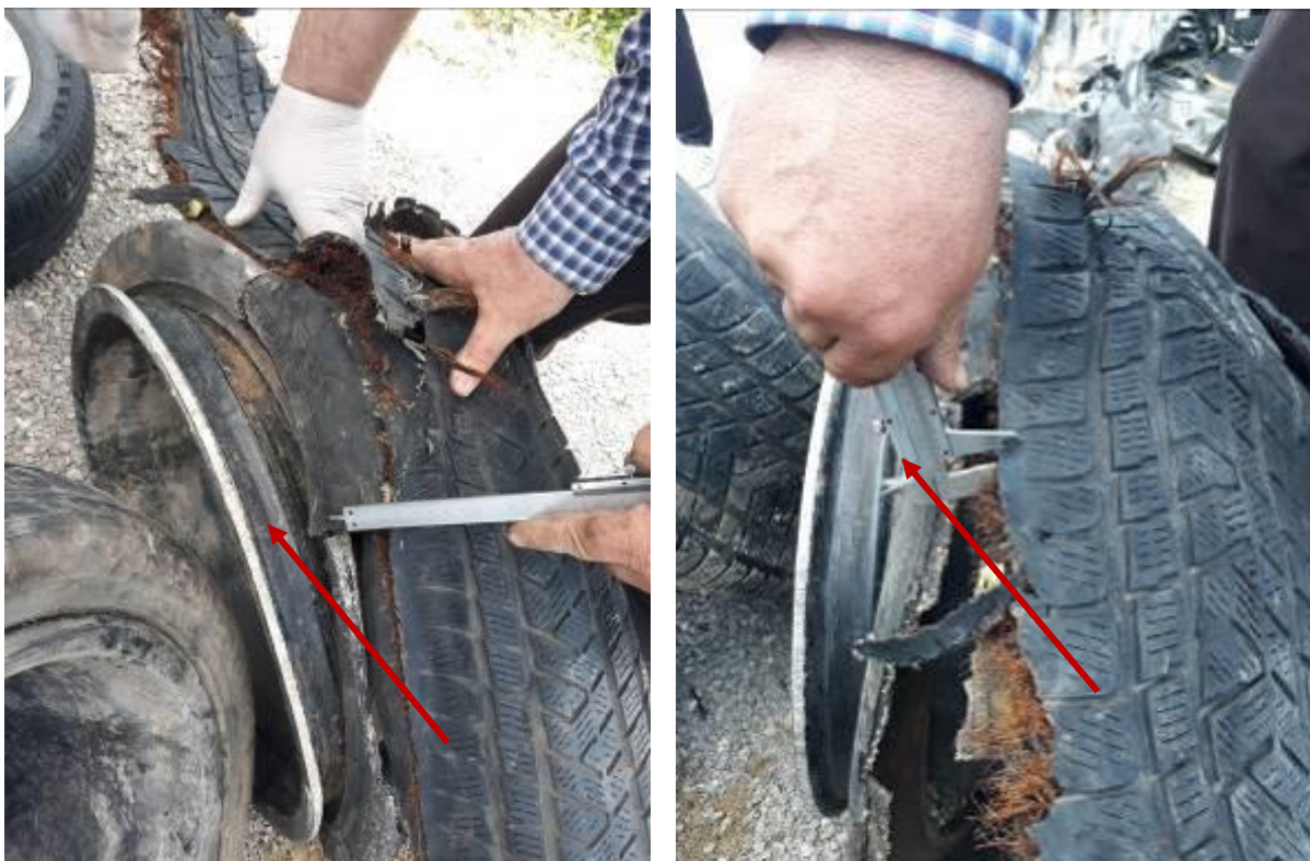
Figura 5.19. Pjesa e brendshme shkelëse e konsumuar e gomës dhe matja e trashësisë së pjesës së brendshme shkelëse të konsumuar të gomës në kahun e rrotullimit të rrotës trashësia 8-9 [mm] (Fotografitë gjatë Ekzaminimit të gjendjes teknike të automjetit)
