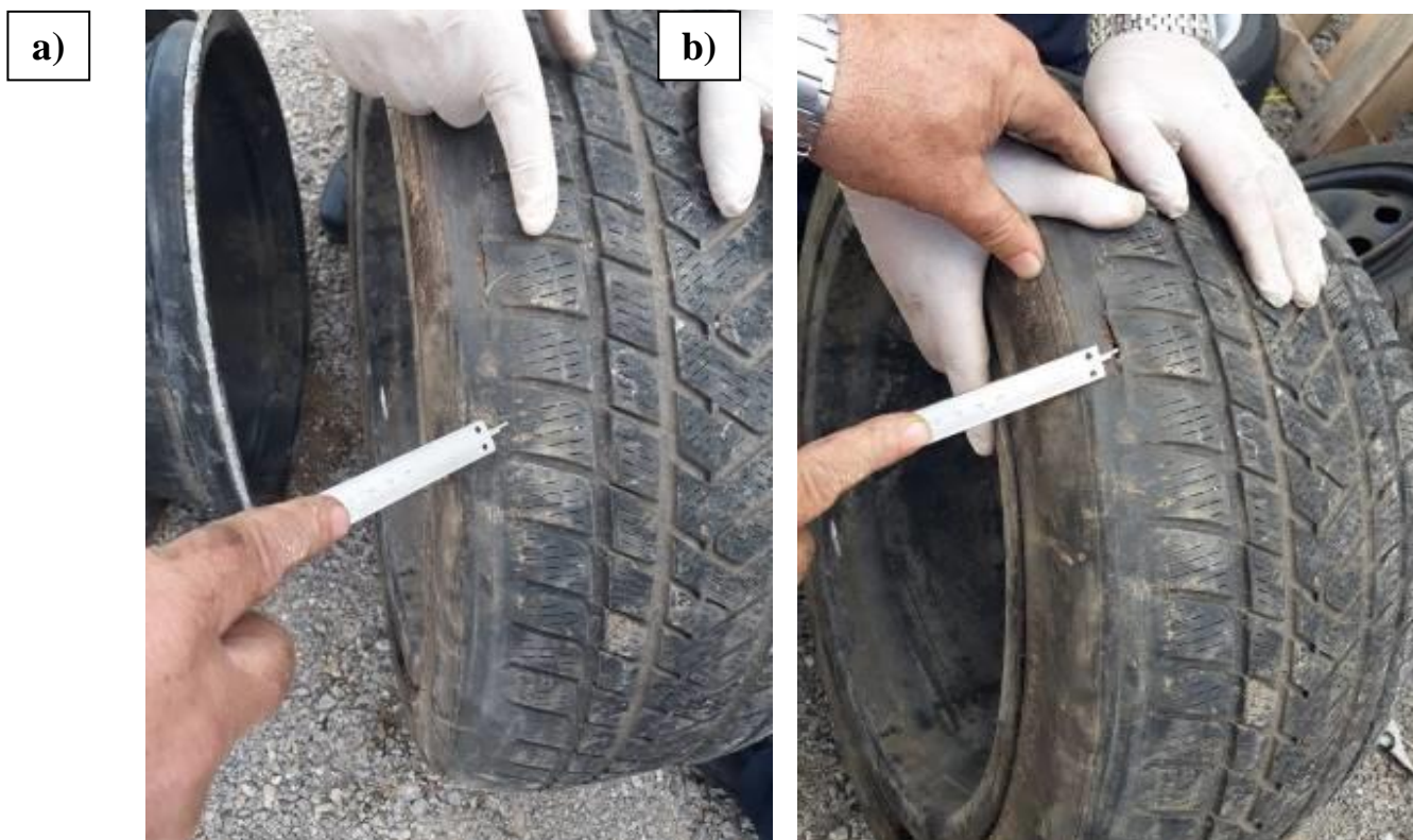
Figura 5.26. a) Ana e brendshme e sipërfaqes shkelëse të gomës - e konsumuar dhe
