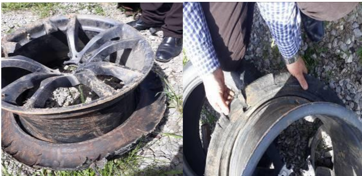
Figura 5.12. Disku i dëmtuar i rrotës së bashku me pjesë të gomës (pneumatikut) të dëmtuar të mbetura në disk gjatë Ekzaminimit të gjendjes teknike të automjetit
