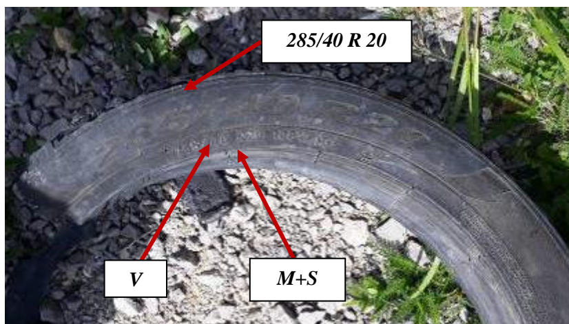
Figura 5.13. Pjesë të pneumatikut të rrotës së djathtë të pasme, me shënimet në pjesën anësore të pneumatikut, dimensionet e gomës 285/40 R 20. Shënimi tjetër me rëndësi: 108V; M+S - simboli i gomave të dimrit
