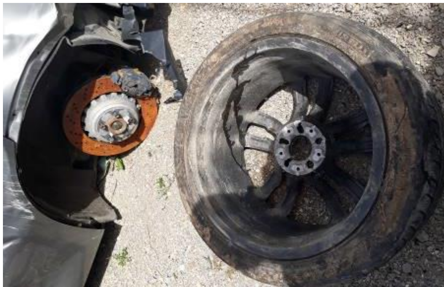
Figura 5.23. Disku i dëmtuar i rrotës së bashku me pjesë të gomës (pneumatikut) të dëmtuar nga ana e brendshme e sipërfaqes shkelëse – kahja e rrotullimit të rrotës (Fotografitë gjatë Ekzaminimit të gjendjes teknike të automjetit)
