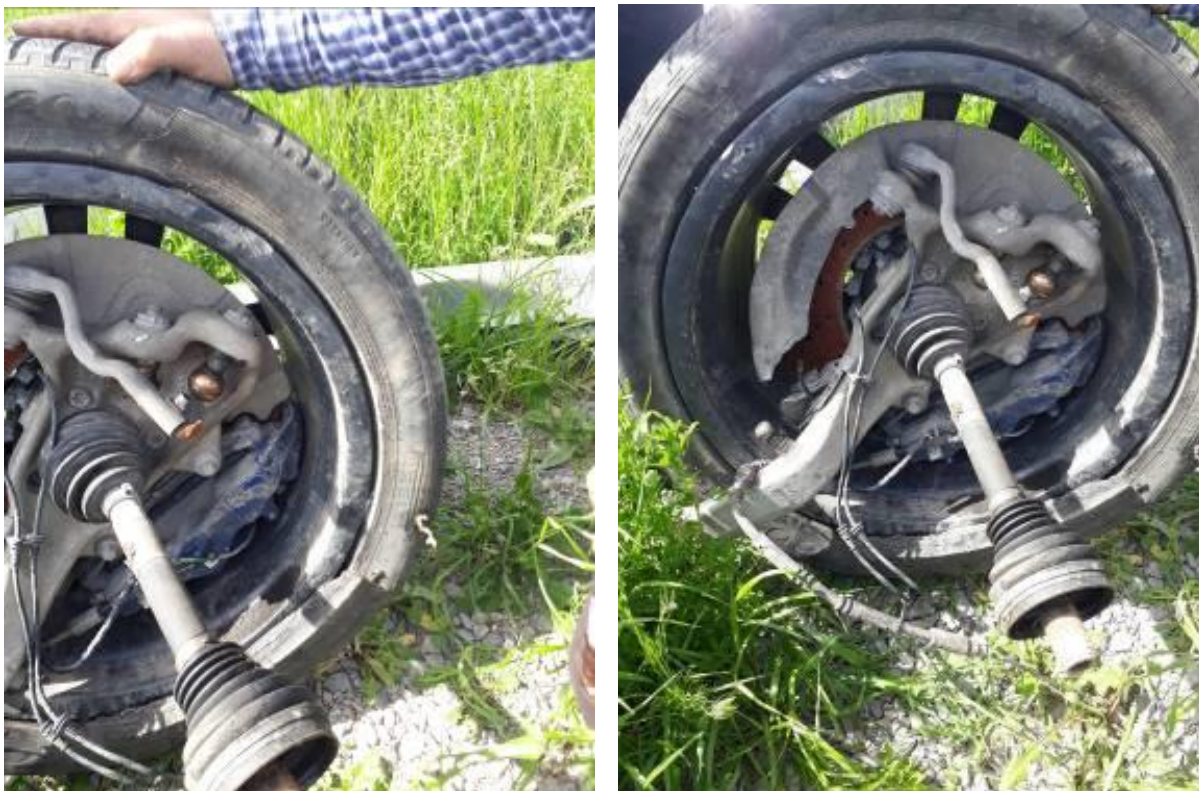
Figura 5.28. Disku i dëmtuar i rrotës përpara – ana e majtë së bashku me pjesë të gomës (pneumatikut) të dëmtuar nga ana e brendshme. Vërehen edhe pjesë të sistemit të frenimit dhe sistemit të varjes në rrotë
