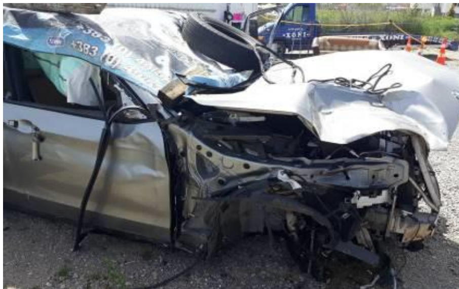
Figura 5.33. Ana e parme e automjetit ku ka qenë e montuar rrota e përparme - ana e djathtë.
