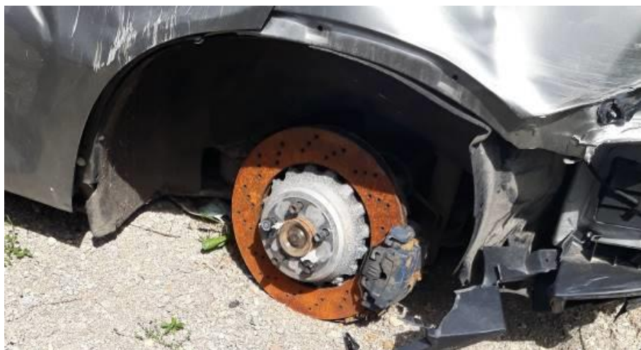
Figura 5.24. Disku i dëmtuar i boshtit me bulonat e dëmtuar (Fotografitë gjatë Ekzaminimit të gjendjes teknike të automjetit)
