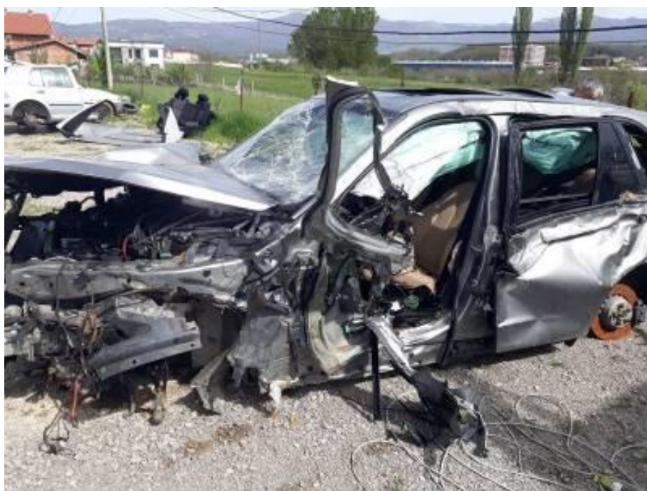
Figura 5.30. Ana e majtë e automjetit ku ka qenë e montuar rrota përpara – ana e majtë. Vërehet dëmtim i madh i pjesës ku montohet rrota
