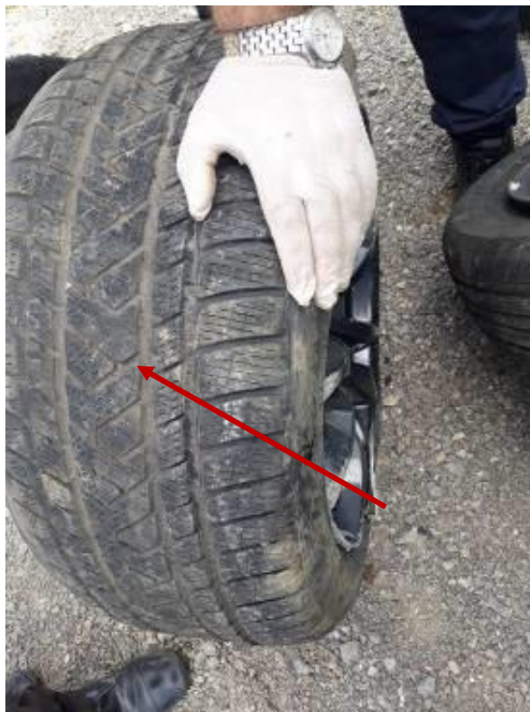
Figura 5.27. Pjesa e jashtme e sipërfaqes shkelëse të gomës - më pak e konsumuar (Fotografitë gjatë Ekzaminimit të gjendjes teknike të automjetit)
