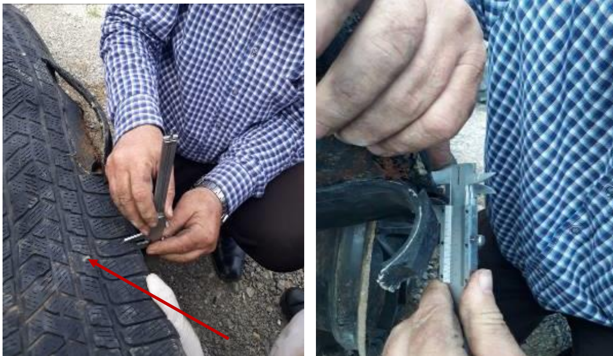
Figura 5.20. Matja e trashësisë së pjesës shkelëse të jashtme të gomës e cila është më pak e konsumuar- trashësia 13-15 [mm] (Fotografitë gjatë Ekzaminimit të gjendjes teknike të automjetit)
