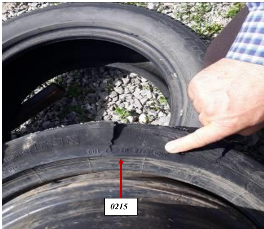
Figura 5.14. Pjesë të pneumatikut të rrotës së djathtë të pasme, me shënimet për datën e prodhimit të gomës 0215 (Fotografitë gjatë Ekzaminimit të gjendjes teknike të automjetit)
