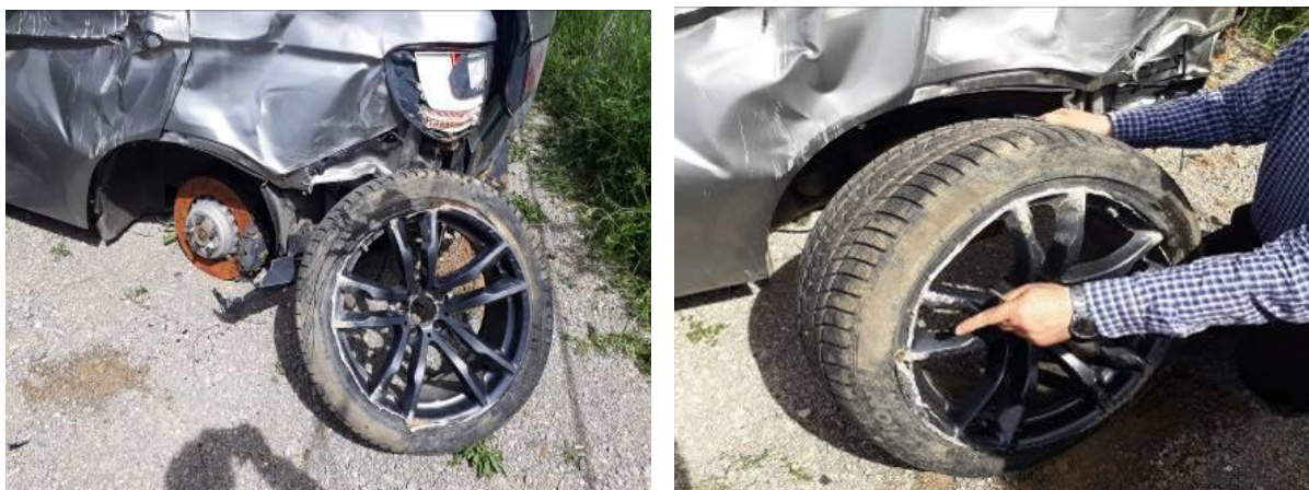
Figura 5.22. Disku i dëmtuar i rrotës së pasme të majtë së bashku me pjesë të gomës (pneumatikut) të dëmtuar nga ana e jashtme e sipërfaqes shkelëse – kahja e rrotullimit të rrotës (Fotografitë gjatë Ekzaminimit të gjendjes teknike të automjetit)
