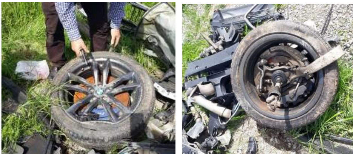
Figura 5.31. Disku i dëmtuar i rrotës përpara – ana e djathtë së bashku me gomën (pneumatikun) nga ana e jashtme dhe e brendshme. Vërehen edhe pjesë të sistemit të frenimit dhe sistemit të mbështetjes të bashkangjitura në rrotë
