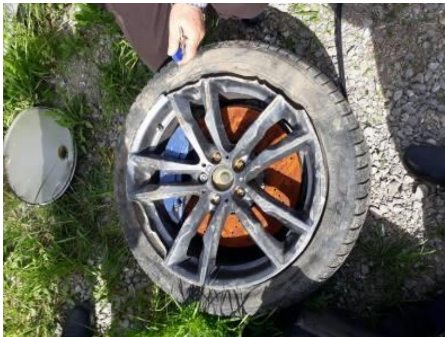
Figura 5.29. Disku i dëmtuar i rrotës së parme të anës së majtë së bashku me gomën (pneumatikun) e dëmtuar nga ana e jashtme (Fotografitë gjatë Ekzaminimit të gjendjes teknike të automjetit)
