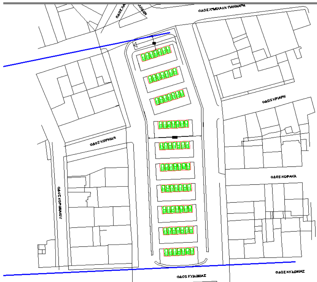
Σχ. 3.6. Υπόγειοι χώροι στάθμευσης κάτω από την πλατεία 1866.
