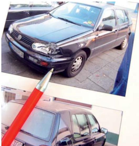
Wirtschaftlicher Totalschaden und abends nicht mehr verkehrstüchtig: VW Golf III mit zwei beschädigten Scheinwerfern
