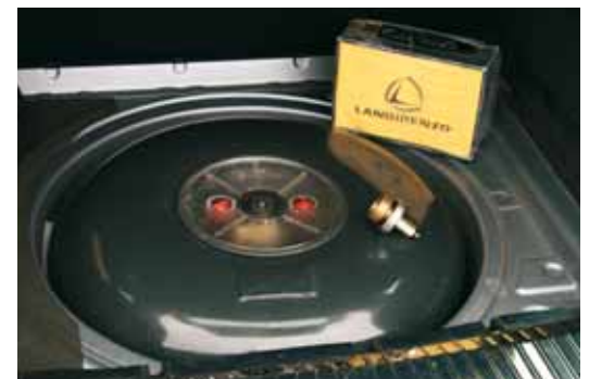
Der Autogastank. Ein Reparaturkit (rechts oben) ersetzt das Reserverad. Darunter ist der Adapter für die Tanköffnung zu sehen. (u.)
