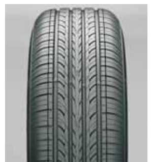
Form, Größe und Anordnung der Lamellen minimieren den Rollwiderstand ebenfalls (u.)
