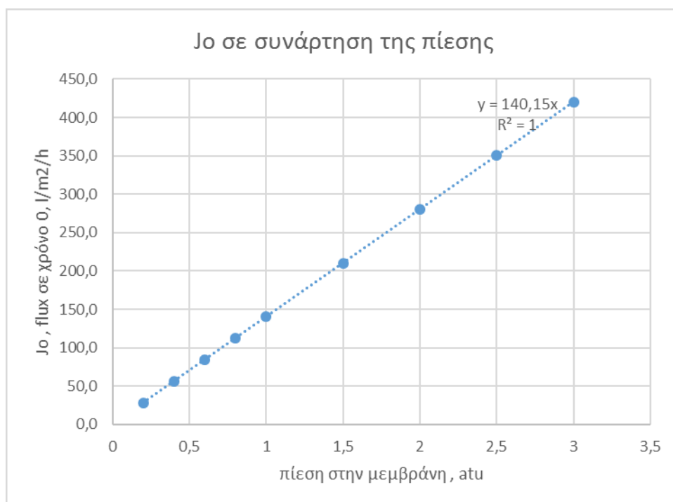
Εικόνα 5: Ταχύτητα διήθησης J_o συναρτήσει της πίεσης
