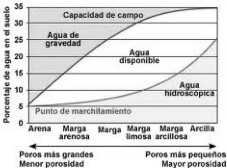
FIGURA 24: CONDICIONES DE HUMEDAD PARA SUELOS DE DIFERENTES TEXTURAS
