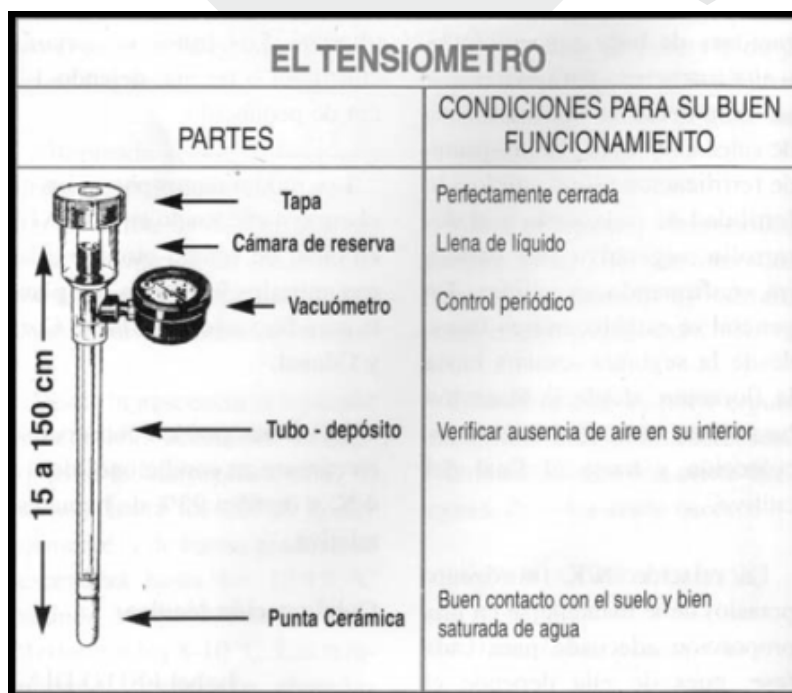
FIGURA 16: CONDICIONES PARA EL BUEN FUNCIONAMIENTO DEL TENSÍMETRO
