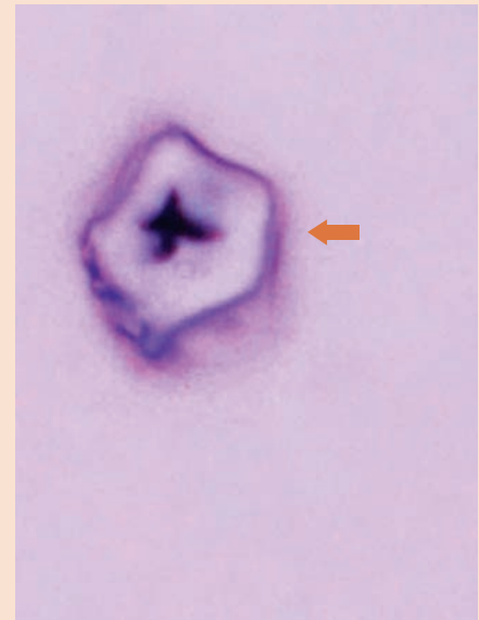
Figura 12. Señalado con flecha se observa polvo de talco.
