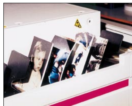
Die Bild-vom-Bild-Aufträge werden auf konventionelles RA4 Papier belichtet.
