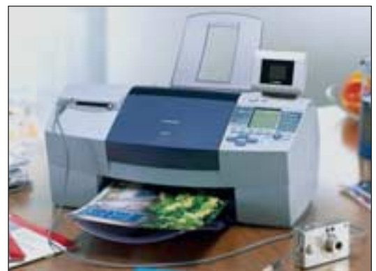
Eine Reihe von Canon-Digitalkameras kann direkt mit dem S530D verbunden werden, für alle anderen bietet der Drucker Speicherkartenslots für die gängigsten Speicherkarten.
