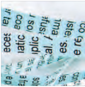
Sicherheitsstufe 1 · Streifen Zerkleinerung Nr. 4 > 6 mm
