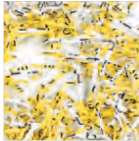
Sicherheitsstufe 5 · Partikel Zerkleinerung Nr. 8 0,78 x 11 mm
