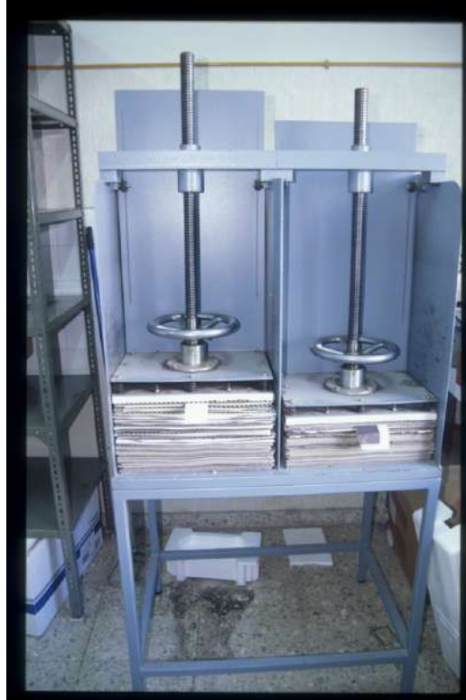
Foto. XX. Prensa de aire caliente para el secado de ejemplares
