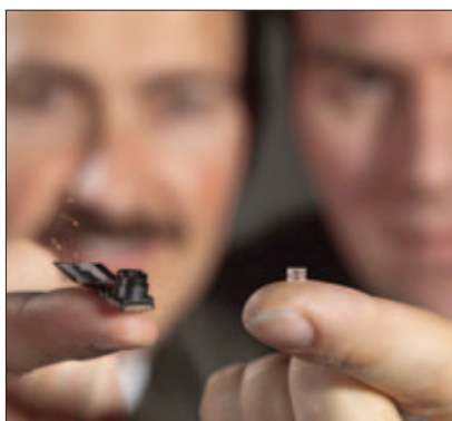
La lente líquida de Philips tiene 3 mm de diámetro.
