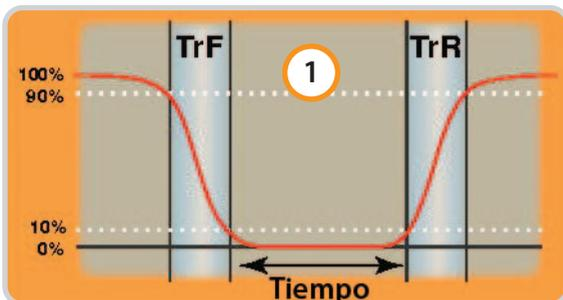
**Foto 1.** La medida del estándar ISO sobre el tiempo de respuesta a nivel de píxel calcula el tiempo tomado por un píxel en apagarse (*fall*), desde el 90% de brillo hasta el 10%, más el tiempo tomado en encenderse, desde el 10% hasta el 90% de brillo (*rise*).
