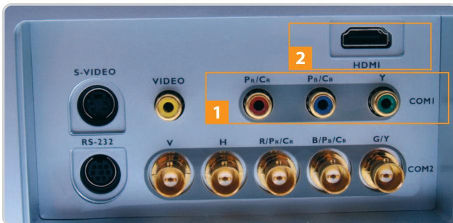
Los conectores de los que disponga cada dispositivo definirán en parte su versatilidad. En el caso de los proyectores compatibles con HD, los interfaces de conexión recomendables son dos: por medio de una conexión analógica del tipo **vídeo por componentes (YPbPr) [1]** o bien por una digital mediante un **conector DVI o HDMI [2]**.
