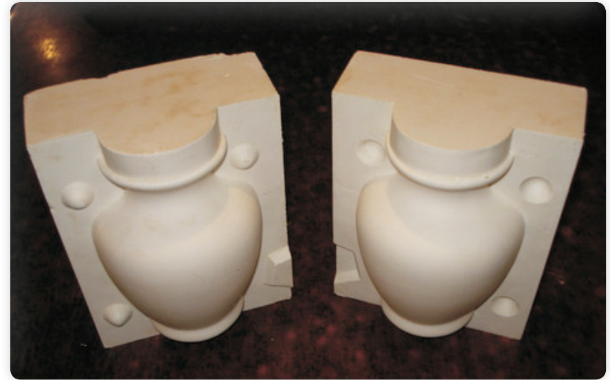
Matriz sin encofrado
