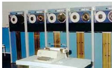
Fotografia przedstawia napędy dysków taśmowych komputera III – ciej generacji „ODRA 1305”
