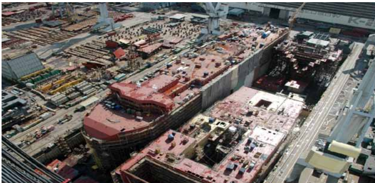
Montaż kadłubów w SD II. Po lewej na fotografii kadłub samochodowca 8245. Po jego lewej burcie, w pobliżu rufy widać „schocki” utworzone ze zbiorników przyburtowych (kolejnego kontenerowca montowanego w SD II) na których będą mocowane kontenery.
