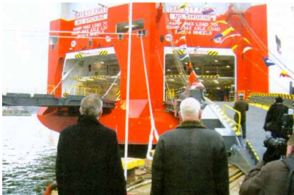
„SEINE HIGHWAY” czyli 8145/4 przekazany do eksploatacji. Statek z klasą lodową! Widok na rufę; widoczne dwa wjazdy do wewnętrznych przestrzeni ładunkowych (dwie rampy rufowe)
