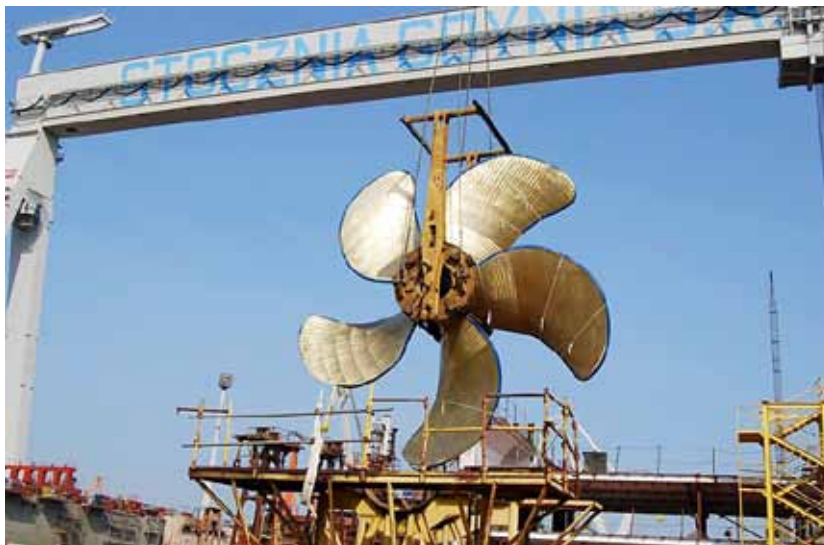
Fotka przedstawia widok na śrubę napędową zawieszoną do opatentowanego uchwyty dwudzielnego. Śruba wisi na dźwigu nr 2 i jest gotowa do transportu (w powietrzu) do niecki dokowej, gdzie zostanie delikatnie wstawiona w specjalny wózek. Po zwolnieniu zaczepów, uchwyt zostanie zdemontowany, zaś wózek z śrubą zostanie przesunięty do miejsca montażu pod rufę statku.
