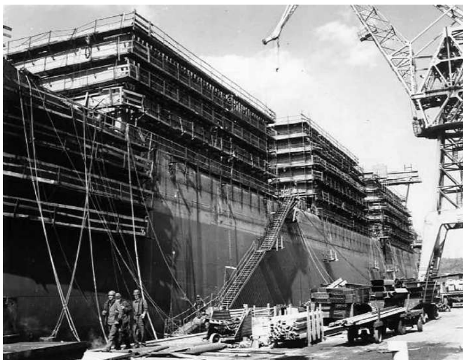
Jedną ze specjalności Gdynińskiej Stoczni im. Komuny Paryskiej są statki dużego tonażu. Na zdj.: budowa 55-tysięcznika dla armatora szwedzkiego. Będzie to jednostka przystosowana do przewożenia samochodów osobowych. CAF – Uklejewski
