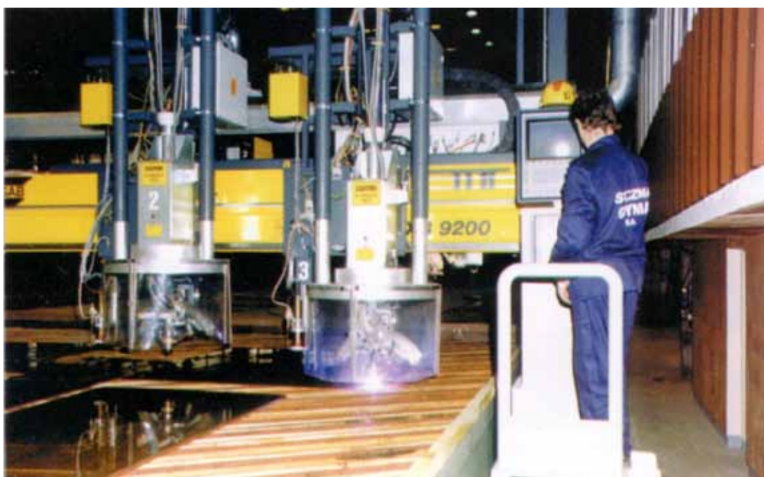
W czerwcu ub. r. oddano do eksploatacji drugą sterowaną numerycznie maszynę plazmową do rozkroju blach
