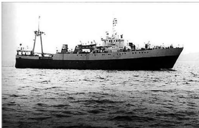
Rok 1963. Trawler zamrażalnia typu B-23 ALBAKORA. Po raz pierwszy w budowanych w stoczni statkach rybackich zastosowano pochylnię rufową zmieniając tym samym technologię połowów. Równocześnie skończył się etap produkcji trawlerów burtowych dla polskich rybaków.
