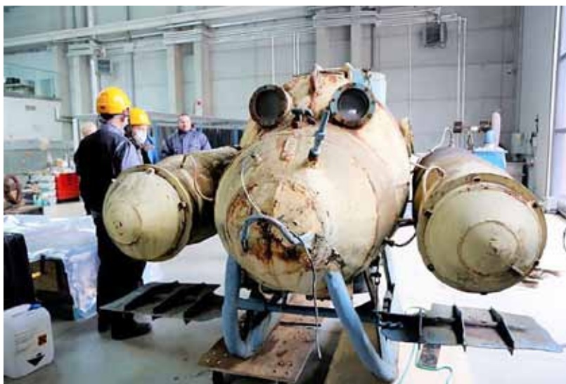
Delfin II Podwodny szybowiec, mógł operować do głębokości 140 metrów! (domena publiczna).
