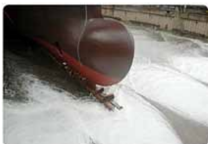
Fotka przedstawia chwilę, w której otwarte zostały zawory umieszczone na bramie doku...
