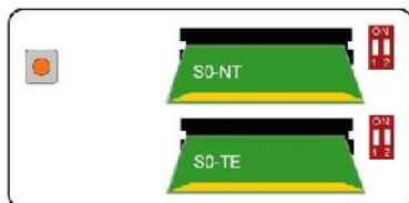
Abb. 13: Mini-Module zur ISDN-Anschlusskonfiguration und Reset-Taster
