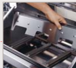
SIMPLE CLEAN: Einzelteile der Brennkammer sind werkzeuglos entnehmbar
