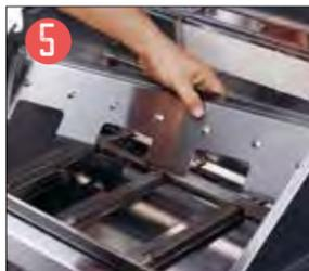
SIMPLE CLEAN: Einzelteile der Brennkammer sind werkzeuglos entnehmbar
