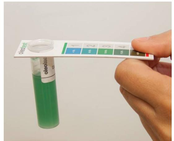
Pruebas para medición de compuestos polares
