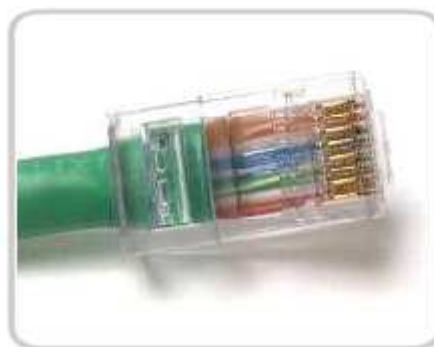
Conector correcto: Los hilos están sin trenzar sólo en el trecho necesario para unir el conector.
