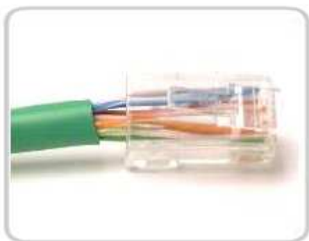
Conector defectuoso: Los hilos están sin trenzar en un trecho demasiado largo.
