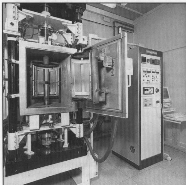
Bild 1. Diffusionsschweißanlage mit Datenerfassungssystem.
