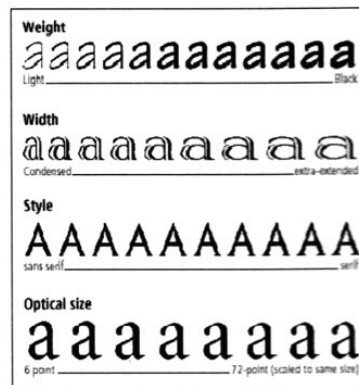
En esta captura de pantalla podemos observar los cuatro ejes posibles en una MultipleMaster: peso, ancho, estilo y escala óptica
