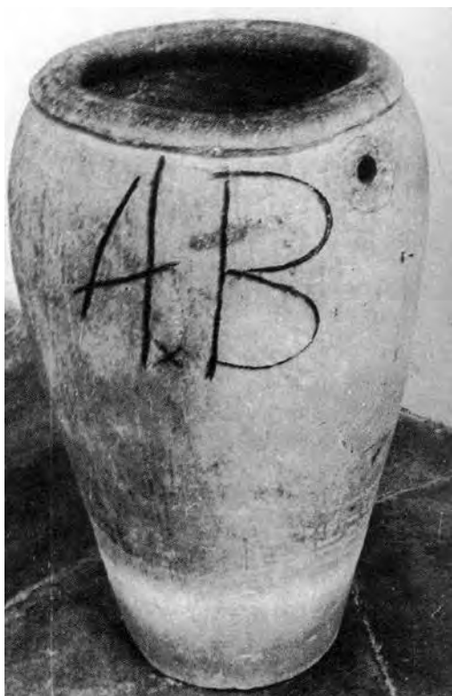
Fig. 4 – “Pignatte” per la distillazione dello zolfo nei cosiddetti “Doppioni” (cf. supra , fig. 2), realizzate a Monte Sasso (Mercato Saraceno) (XVII-XVIII secolo). Esse recano incise, sulle pareti, le sigle dei fabbricanti «A x B» e «F x B»: rispettivamente, Antonio Balducci e Francesco Balducci, entrambi appartenenti ad una famiglia tradizionalmente specializzata in tale produzione (da VEGGIANI 1979).
