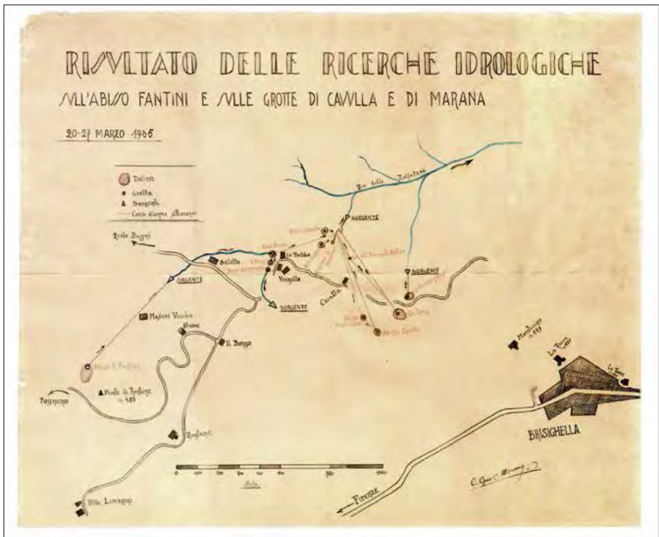
Fig. 8 – Carta idrologica di parte dei Gessi di Brisighella e di Ronzana, disegnata da Giovanni Mornig nel 1935 (da MORNIG 1995). Il corso d’acqua che scorre nel fondo dell’Abisso Fantini non torna a giorno tramite una risorgente ubicata a nord delle “Masere” come indicato nella carta, bensì circa 1,5 chilometri a nord-ovest, tramite la Risorgente del Rio Cavinale. Mornig fa inoltre convergere le acque delle Grotte Biagi e Brusini [sic] con quelle dell’Abisso Acquaviva e della Grotta Rosa Saviotti in un’unica risorgente. In verità si tratta di due distinte risorgenti, separate da poche decine di metri. Infine, le acque del Buco del Noce dovrebbero, secondo Mornig, tornare a giorno poche decine di metri a nord della cavità tramite una risorgente che però non è mai stata individuata.
