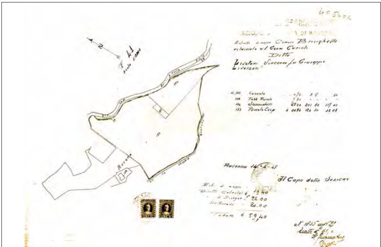
Fig. 66 – Mappa datata 14 aprile 1947 relativa all’area della cava Marana, all’epoca coltivata solo a cielo aperto. Il profilo del ciglio del fronte di abbattimento è rilevabile, sulla carta, in uno “scasso” quadrangolare irregolare ricavato nel substrato, a ovest di Ca’ Marana. Accanto all’odierna strada Brisighella-Riolo posta in corrispondenza del contatto tra gessi ed Argille Azzurre, la carta riporta anche una più antica «Via Vecchia Rontana» che correva sul crinale gessoso. Nell’ intestazione della mappa, la gestione del sito estrattivo è erroneamente indicata come «Ditta Liverzani Vincenzo fu Giuseppe Liverzani», omettendo che all’epoca ne erano soci anche i Malpezzi, i quali successivamente ne diventeranno i gestori unici. La carta appare derivata da fogli catastali; scala originale 1:2000 (ADMB; già edita precedentemente in PIASTRA 2008).
