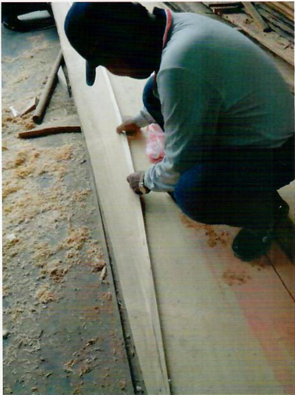
用小鐵釘將木條左右夾夾，使木條沿對應處記號線固定，做出「大波」上緣的弧線。
