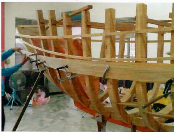
將長木片固定在船肋上， 做「大波」的模板。
