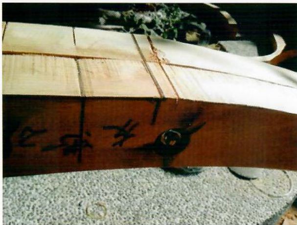
船肋底部與龍骨銜接處的左右兩側刻出 槽溝，用以集中船底水，以便清潔。
