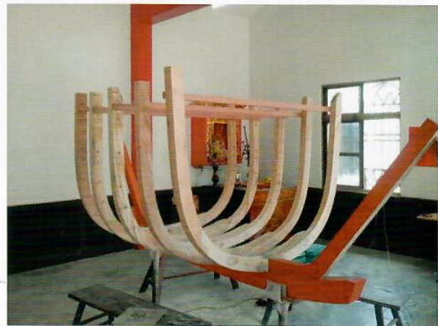
全部安裝於龍骨上的船肋
