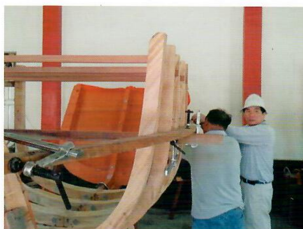
牽架固定船肋，整出船身弧度
