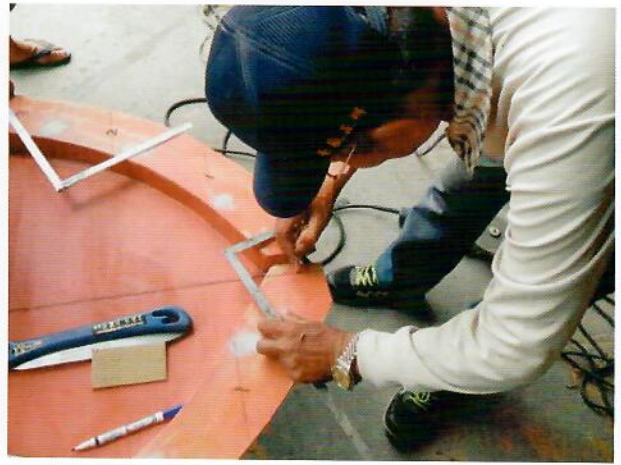
調整與「曲」銜接處的寬度
