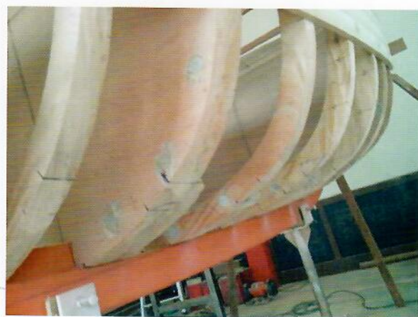
刨整、打磨後的船肋。
