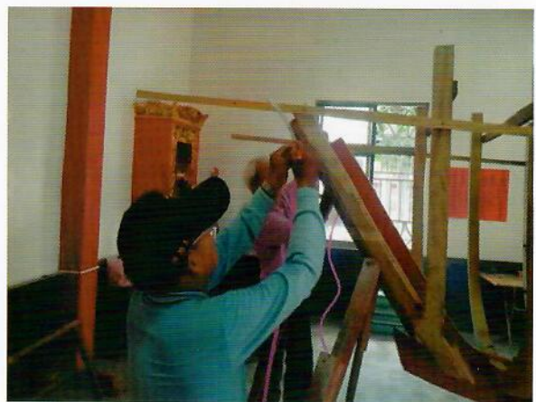
水平管量左右側高度，畫記，使上「大波」時左右側能等高。
