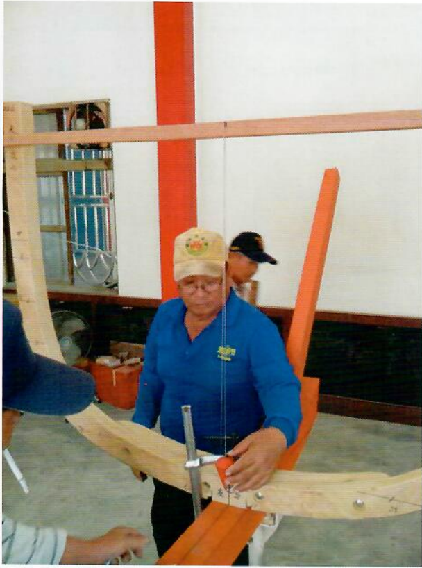
從船肋中點墜鉛錘，調整對準龍骨中線
