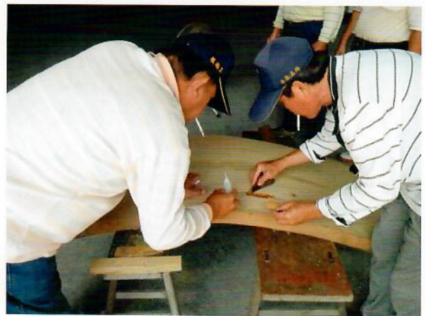
用快乾和香粉修補船艙木料上的細縫
