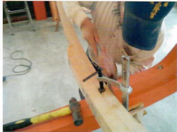
固定「表2」，將「表2」與「前營曲」 之間的凹凸處鋸除，確保兩者能緊密 貼合
