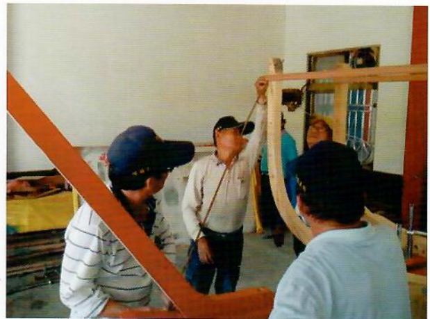
再由「0號」右側外緣拉線至龍骨，測量船肋頂端左右兩側至龍骨距離是否相同，若不同會導致船身有內凹外凸的情形。
