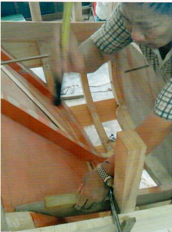
擊打「抽」，使「抽」與船艙隔板密合
