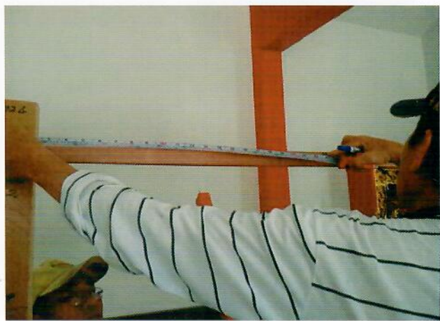
又從右側外緣向量 1 尺 1 寸 2 分作標 記，再找出左右兩側標記的中點，此 即船肋中點。
