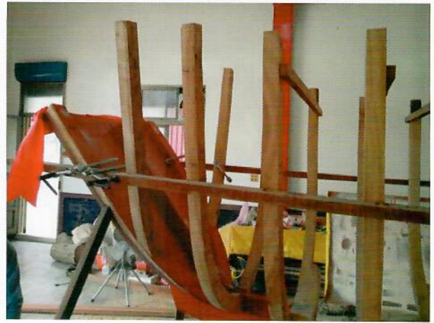
安裝完成的「表3」和「表4」
