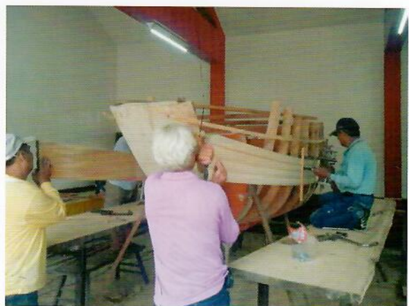
左右邊同時由後往前以V形萬力夾固定在船肋上，組員在前方抬著「大波」。
