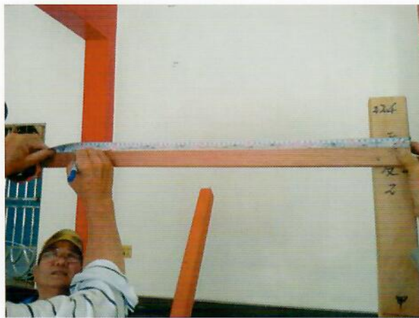
找出兩船肋上端中心。「友2」上寫 224 表示兩端距離 2 尺 2 寸 4 分，自左側外 緣向內量 1 尺 1 寸 2 分作標記。
