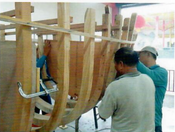
安裝船艙隔板
