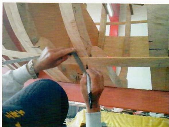
繪製「水底」模板， 方式與「大波」相同。
