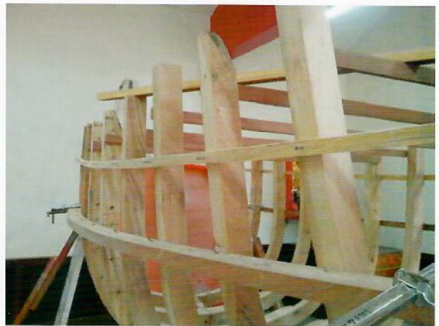
船肋間牽木條，觀察船肋與木條是否密合，以便削整船肋，使船殼能與船肋緊貼，不會出現某處凸起，某處凹陷的情形。
