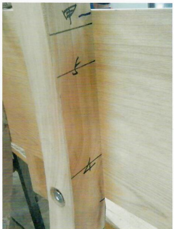
船肋與「大波」相接，上下兩記號線即「大波」的上下緣。
