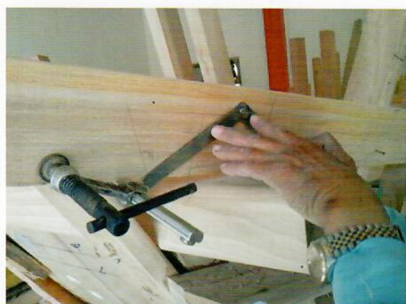
大刀頭製版--測量角度
