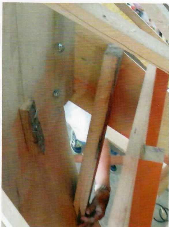
「前營」與船艙間填柴，固定在「大波」，增加「大波」的厚度和穩定。
