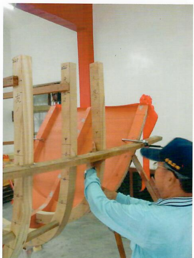
測量「友3」與曲和支架間的密合度，量取要削去的部份
