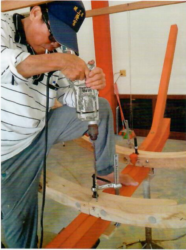
確認對準中線且左右對正後即鑽孔， 先鑽釘「0號」船肋。
