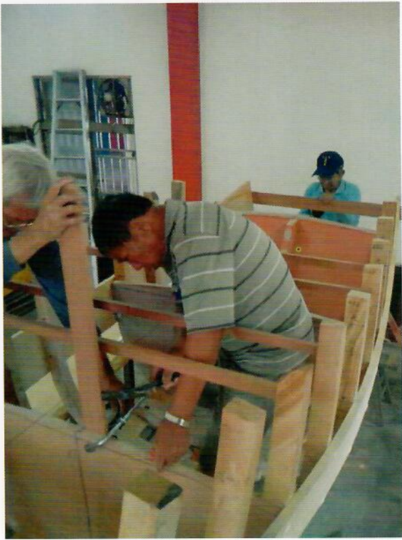
測量中桅在船身中線，使中桅 剛好位於「含壇」中間。
