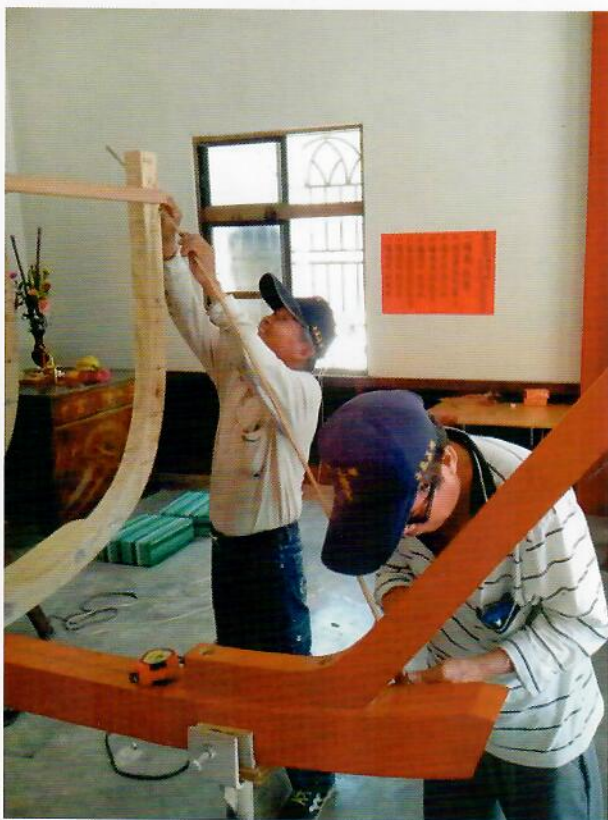
從「0號」左側外緣拉線至龍骨，標記距離。
