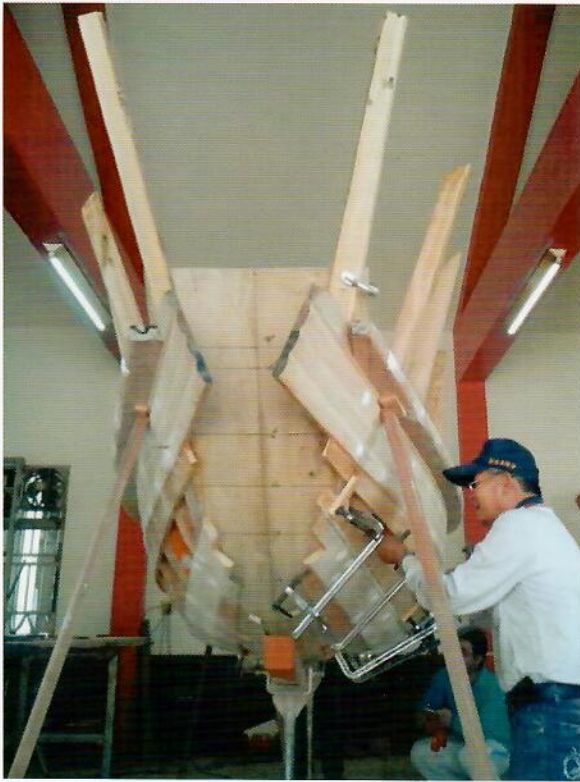
裝釘完成的船堪與即將完成的船殼。
