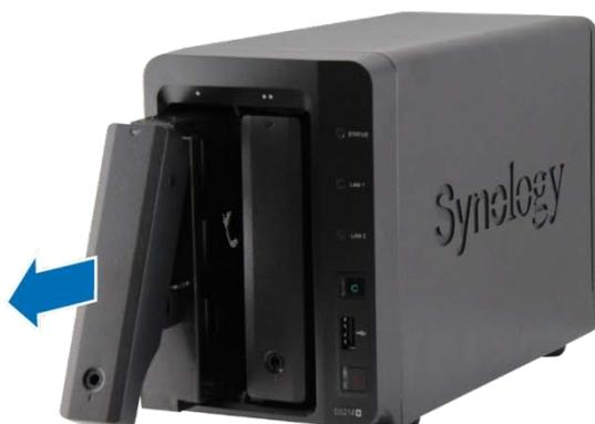
3 Legen Sie die Laufwerke in die Laufwerkträger ein.
