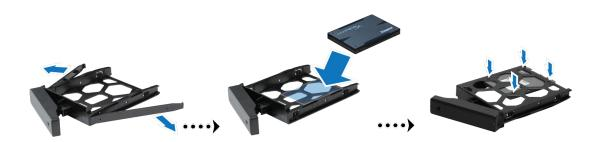
4 Setzen Sie den Festplattenträger mit der Festplatte in das Festplattenfach ein.
