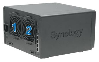
3 Entfernen Sie die 2 Schrauben, mit denen die Lüfterplatte befestigt ist.
