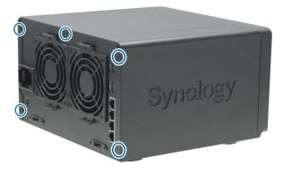
**Wichtig:** Durch Entfernen des Gehäuses werden empfindliche interne Komponenten freigelegt. Berühren Sie nur die Speicherbauteile, wenn Sie Speicher entfernen oder hinzufügen.
