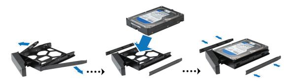
• Für 2,5-Zoll-Laufwerke: Entfernen Sie die Befestigungen von den Seiten des Laufwerkträgers und legen Sie sie an einen sicheren Ort. Legen Sie das Laufwerk in den blauen Bereich (unten dargestellt) des Laufwerkträgers. Drehen Sie den Träger nach oben und ziehen Sie die Schrauben fest, um das Laufwerk an seinem Platz zu sichern.
