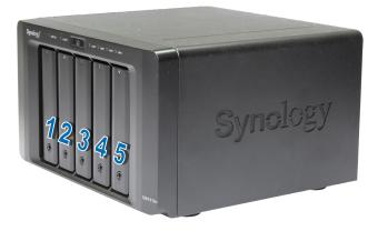
*Hinweis:* Für die Einrichtung eines RAID-Volumes wird empfohlen, Laufwerke der gleichen Größe zu installieren, um die Kapazität der Laufwerke optimal auszunutzen.
