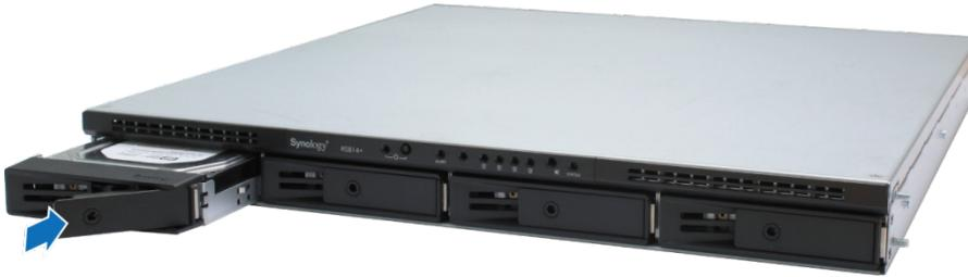
**Wichtig:** Stellen Sie sicher, dass das Laufwerkfach vollständig eingeschoben ist. Ansonsten läuft das Laufwerk möglicherweise nicht ordnungsgemäß.
