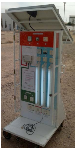
Figure 1 : Photo du panneau, batterie, régulateur, charge et électrolyseur.
