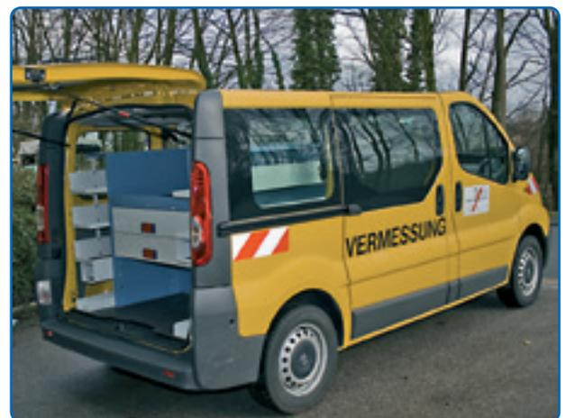
Opel Vivaro mit verstärkter Siebdruck-Bodenplatte zum Werterhalt des Fahrzeugs und zur leichteren Montage der Einrichtung, da bei einigen Fahrzeugtypen die serienmäßig vorhandenen Befestigungsmöglichkeiten sehr ungünstig für den Einbau liegen. In diesen Fällen fungiert der zusätzliche Boden auch als „Brücke“ für die Verankerung.
