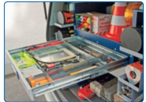
Die obere Schublade ist besonders geräumig. Die untere Schublade - variabel einteilbar - ist mit einer hochklappbaren Abdeckung versehen. Dadurch entsteht ein praktisches Stehpult unter der schützenden Heckklappe.
