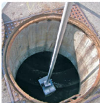
22-210 710 im Schachteinsatz: Der Scanner ist über den Adapter 22-660 040 mit dem Stativ verbunden.
