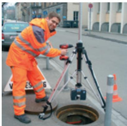
22-210 710 mit optionalen Rollfüßen und Faro-Scanner kurz vor dem Absenken des Scanners mit einem Akkuschauber (nicht im Lieferumfang).
