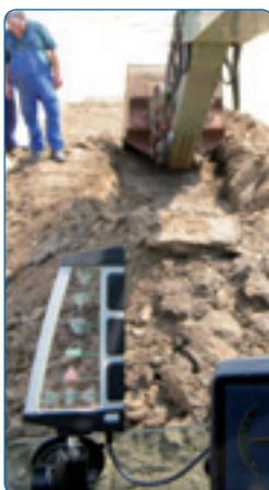
Das transparente Display ermöglicht eine ungehinderte Sicht nach vorn.
