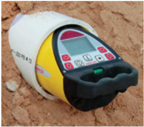
Kompakter geht es nicht: Der LEICA Piper 200 in einem DN100 Rohr...
