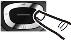
Wollen Sie die Eingabeposition ändern, um z. B. eine Eingabe zu korrigieren, drücken Sie **rechts** oder **links** auf die Steuer-Taste.
