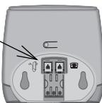
Auf der Rückseite wird das mitgelieferte Netzteil-Kabel in die Buchse gesteckt. Anhand der angegebenen Abmessungen können Sie entsprechende Bohrungen vornehmen, um das Gerät mit Hilfe der mitgelieferten Schrauben und Dübel an einer Wand zu montieren.
