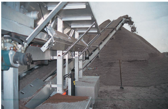
Combinando los materiales de la zona radicular en la planta ofrece numerosas ventajas sobre hacer la mezcla en el sitio de obra.
