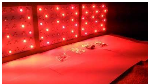
Рисунок 1 – LED-лампа с включенным красным светом и облучаемыми семенами
