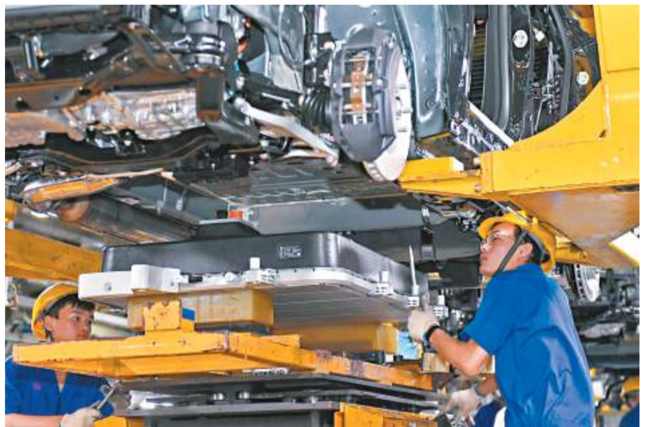
◆前三季度，深圳全市規模以上工業增加值同比增長4.2%。圖為在深圳比亞迪總部，工人為新能源汽車安裝電池。資料圖片
